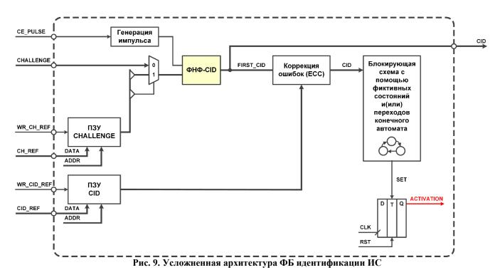
Вектор откликов ФНФ при идентификации должен быть стабильным. Но он может быть зашумлен в связи с изменением температуры, деградацией кристалла со временем и различными помехами. Для избежания этого используют блок коррекции ошибок. Возможны аппаратные реализации различных схем коррекции ошибок, таких как коды Хэмминга, БЧХ-коды и коды Рида-Соломона [20]. На вход данного блока подается идентификатор и вспомогательные данные из ПЗУ СІD.
