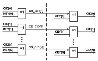
Рис. 11. Дешифрация с помощью XOR
