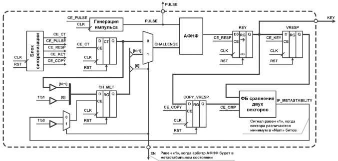
Рис. 16. ФБ генерации ключей для шифрования данных
