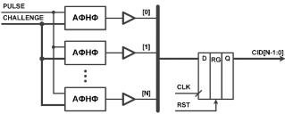
Рис. 6. ФБ получения CID на базе параллельных модулей АФНФ
