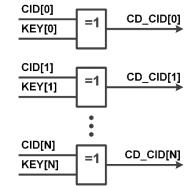
Рис. 10. Шифрование с помощью XOR
