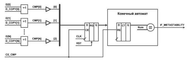
Рис. 17. Схема сравнения двух векторов
