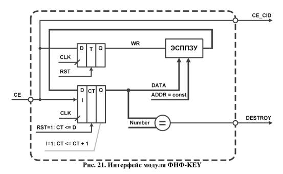
сигнал DESTROY, который можно использовать для разрушения ресурсов микросхемы. Сигнал СЕ также разрешает запись в ЭСППЗУ текущего значения счетчика, выход которого подведен ко входу СТ. Тем самым после подачи питания счетчик установится в последнее значение, лишая злоумышленника использовать аппаратные средства перебора векторов СІD.
