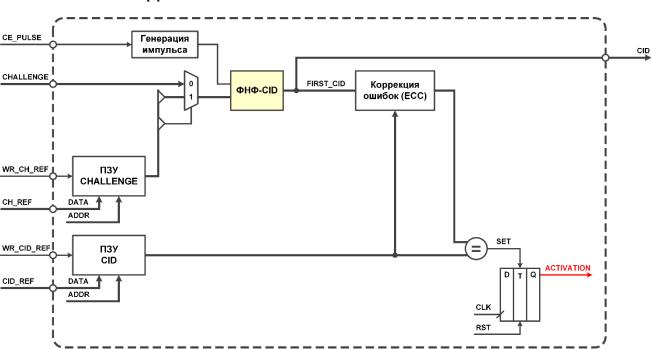
Рис. 8. Классическая архитектура ФБ идентификации ИС
