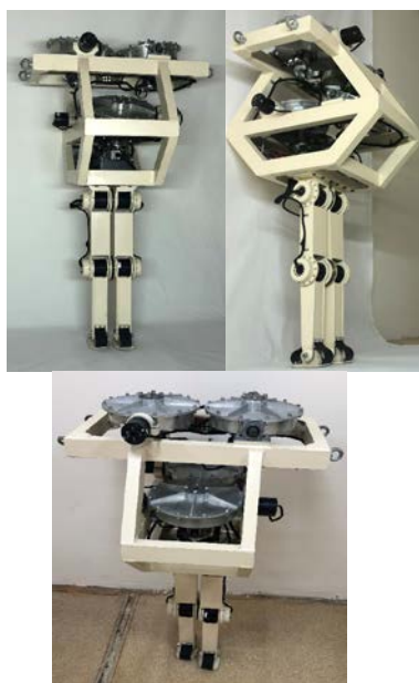
Рисунок 5. Большой двуопорный шагающий робот с небиионической стабилизацией на основе двух пар гироцинов
