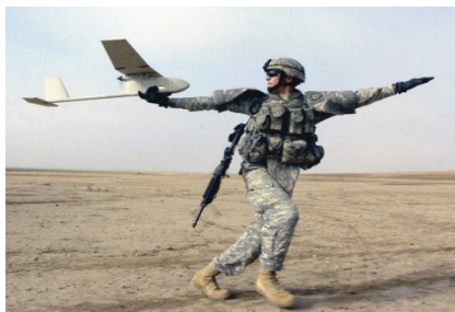
Рис. 8. Беспилотник разведки (весом 2 кг, имеет видеокамеру, инфракрасные сенсоры).
