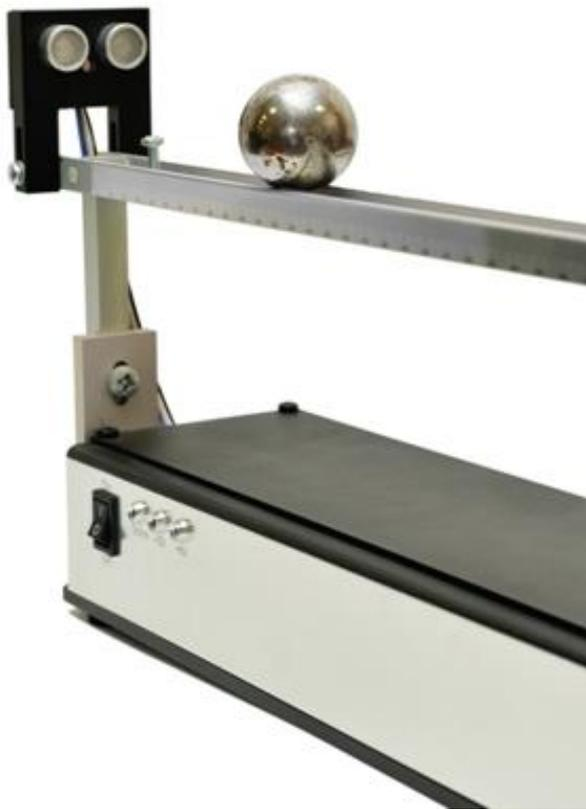
Рисунок 1. Управляемое устройство. Ультразвуковой датчик.
