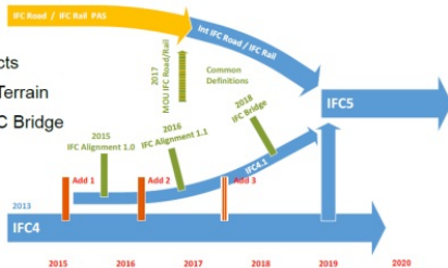
Рис. 12. Для того чтобы отразить все онтологические аспекты IFC RAIL планируется выпустить новую (пятую) версию языка IFC (источник – buildingSmart)
