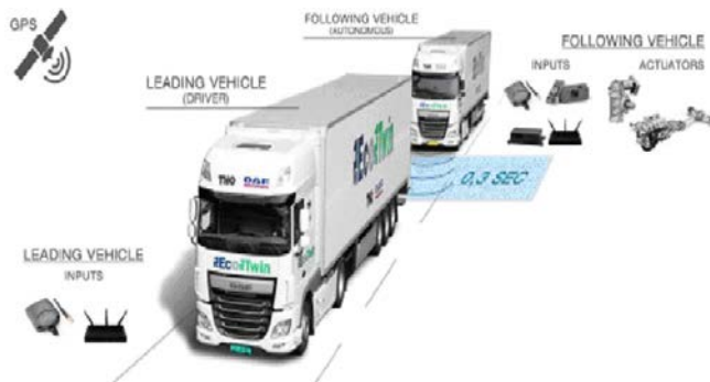
Рис. 3. Пример переоборудования грузовиков для езды взводом (источник -VDI Wissensforum)
