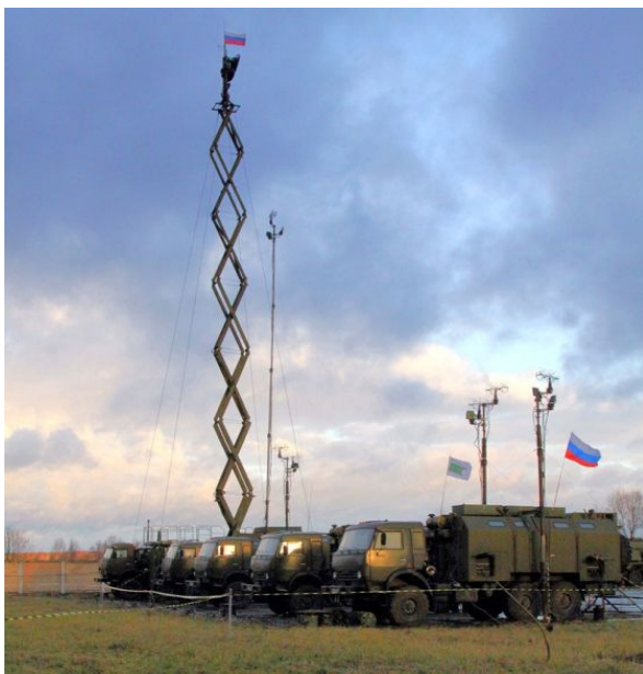
Рисунок 14. «Редут-2УС» – базовый комплекс аппаратных связи и аппаратных управления связью интегрированной цифровой полевой системы связи ОСЗУ и ОЗУ.
