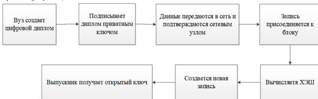
Рис. 3 Механизм работы технологии блокчейн
