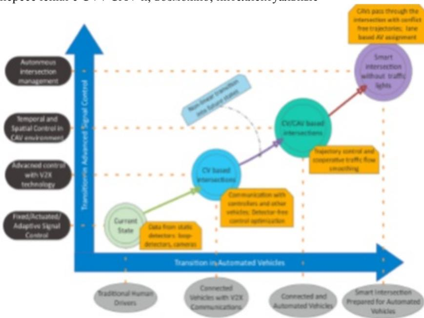
Рис. 49. Переходы в инфраструктуре сигналов и алгоритмах управления в среде CAV / CV [91]
