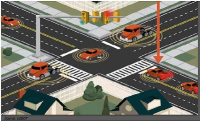
Рис. 46. Предупреждение о нарушении красного света (источник – DOT США)
