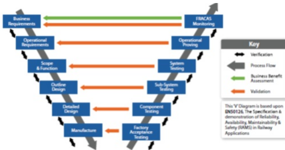
Рис. 39. Эта диаграмма 'V' основана на EN50126 (RAMS) на железной дороге (источник – IAM) демонстрации надежности, доступности и безопасности
