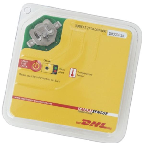
Рис. 21. Развитие RFID в направлении умных датчиков для контроля температурных режимов для транспортировки товаров (источник: DHL).
