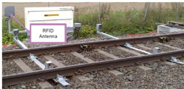
Рис. 25. Конфигурация считывателя RFID с фиксированным размещением на обочине железнодорожного пути (источник GS1)
