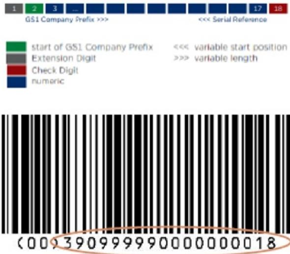
Рис. 14. Вид логистической единицы серийного кода контейнера или SSCC по стандарту GS1(источник: GS1)
