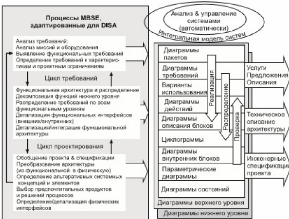
Рис. 11. Процесс разработки новейшей версии GIG по модели MBSE [8]
