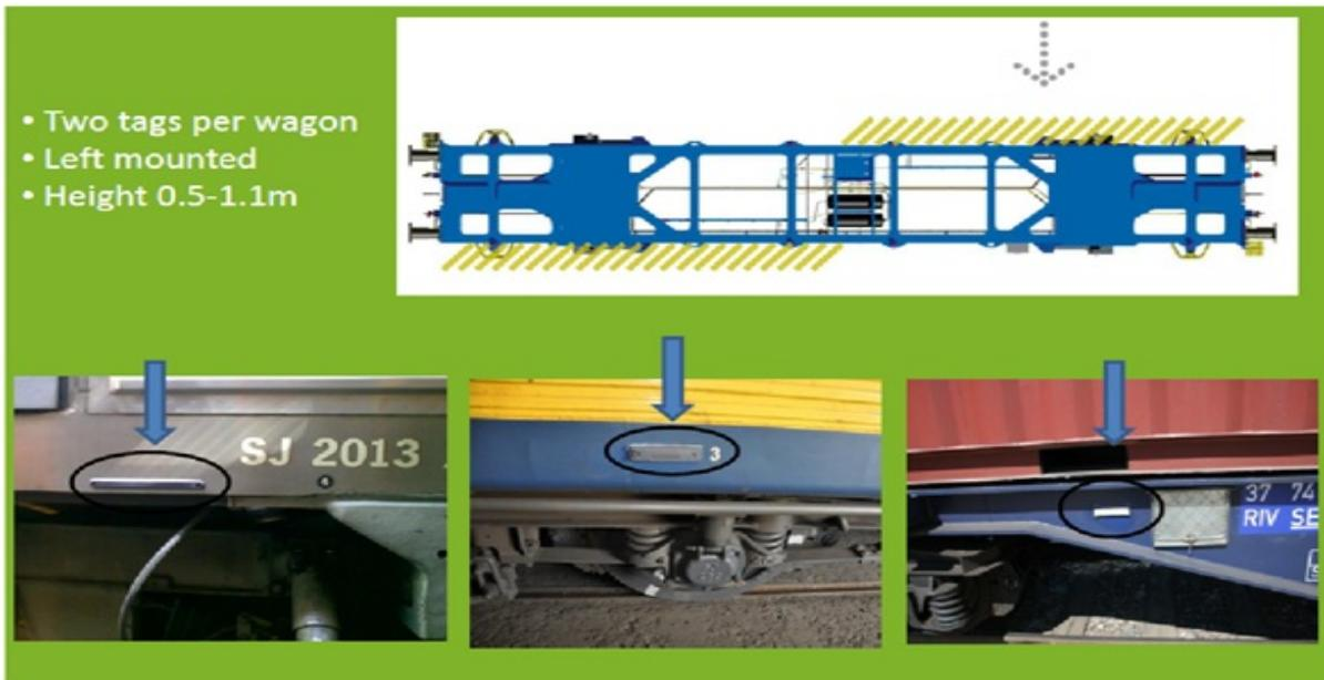
Рис. 5. Размещение тегов RFID на грузовых вагонах (шведские железные дороги)
