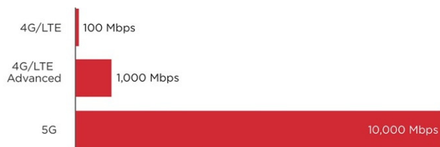
Рис. 12. Теоретически максимальные скорости передачи сетей 4G/LTE и 5G.
