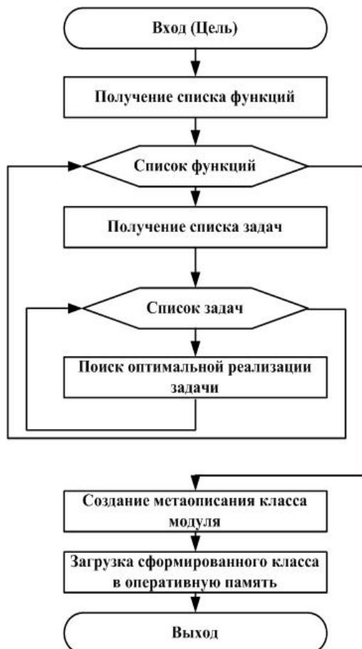
Рисунок 5 – Алгоритм функции конфигурирования оптимального модуля
