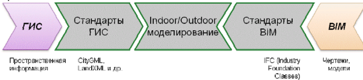
Рис. 5 Гармонизация стандартов и моделей в проекте внедрения BIM-ГИС в отрасли архитектуры и строительства в Южной Корее
