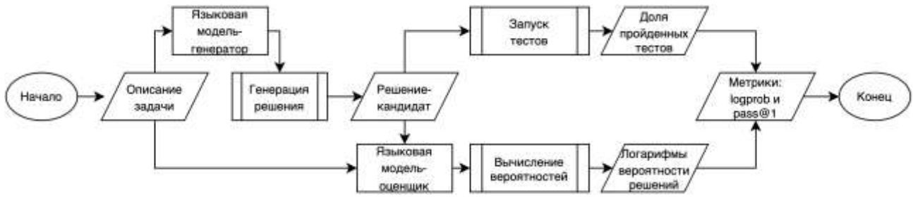
Рис. 1. Схема экспериментального пайплайна оценки решений с использованием логарифмов вероятности и автоматического тестирования
