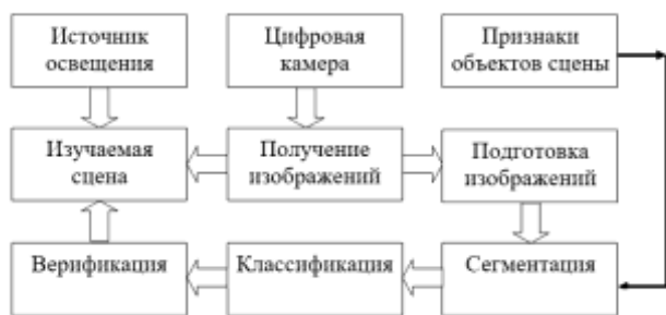
Рис. 1 — Последовательность формирования и обработки цифровых изображений в задаче автоматизированного анализа состояния растений
