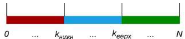
Рис. 2. Отрезок с тремя областями: отрицательных (красный), неопределенных (голубой) и положительных (зеленый) решений группы, состоящей из N акторов
