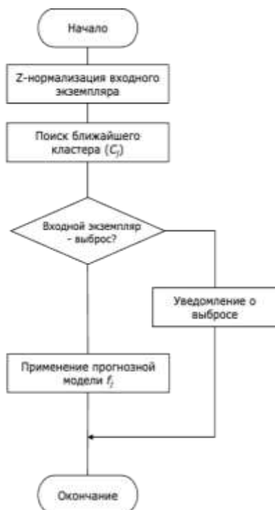
Рис. 2: Алгоритм применения прогнозных моделей при использовании кластеризации
