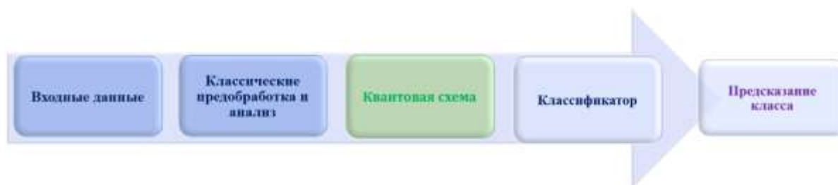
Рис. 6. Схема гибридного конвейера машинного обучения для задачи классификации
