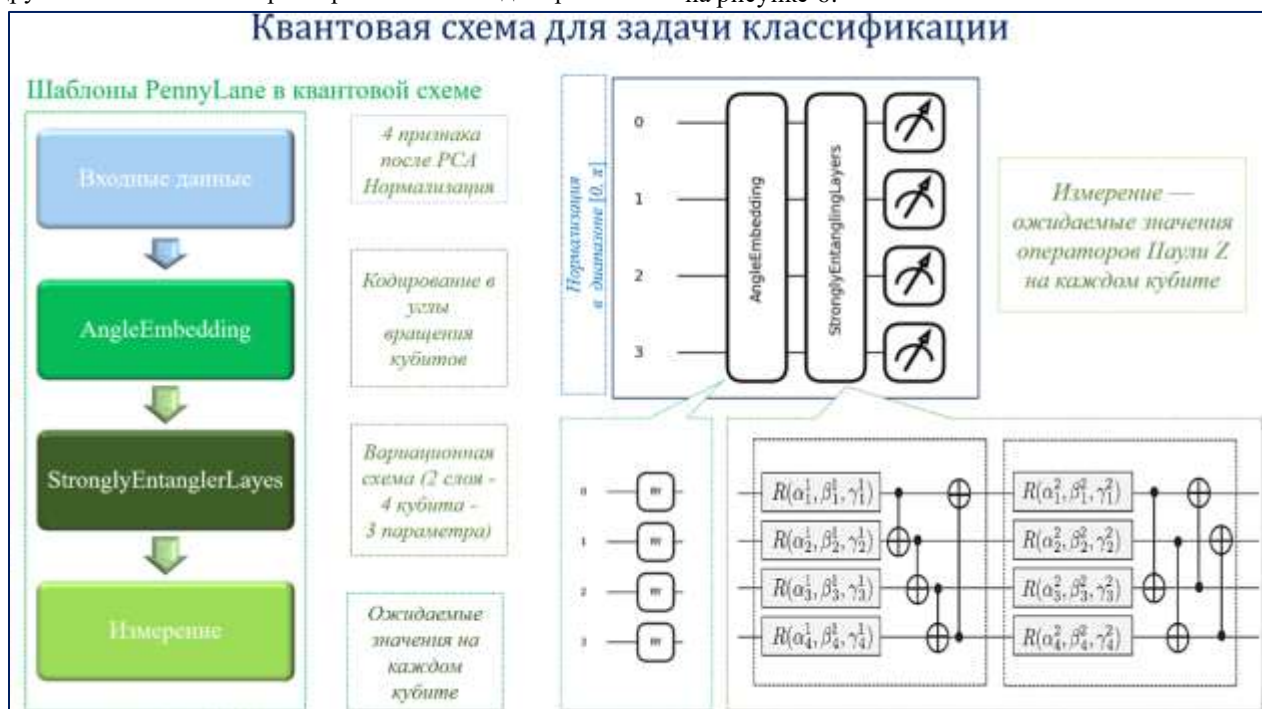
Рис. 7. Квантовая схема для задачи классификации
