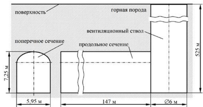
Рис. 1. Ориентировочные проектные размеры горной выработки ПИЛ
