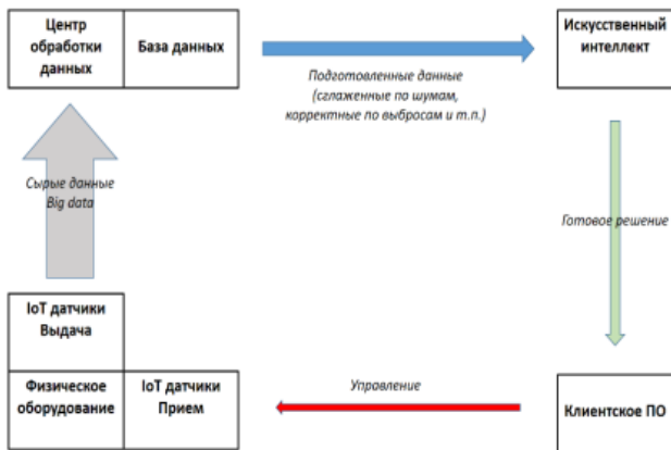
Рис. 1. Принципиальная схема работы ИС ЦД буровой установки на основе машинного обучения
