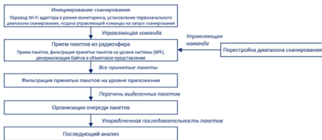
Рисунок 7 – Основные этапы проведения сканирования радиочастотных диапазонов Wi-Fi
