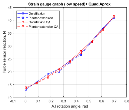
Рис. 15. Экспериментальный и аппроксимированный график (скорость - 0,035 рад/с, время цикла - 20 с, уравнения - y = 27,33x^2 + 20,80x + 13,63 для подошвенного сгибания и y = 32,27x^2 + 17,00x + 13,78 для тыльного разгибания)
