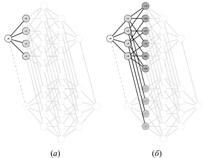
Рис. 4 – Вершины типов 0 и 1 под пунктом а, и под пунктом б вершины типа 0, 1, 2 и предполагаемые вершины типа 2 при вложении в каждое МР-1-Р 5-куба с удалённым ребром  $\{v_0, v_N\}$  при отображении вершины  $0...0$  гиперкуба в  $v_0$
