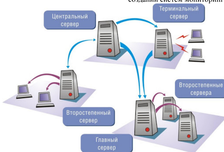
Рис. 1 – Принцип построения распределенной архитектуры
