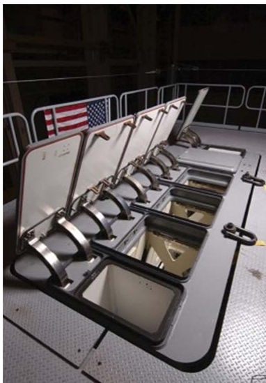
Рис. 46: USS Zumwalt. Система вертикального пуска ракет
