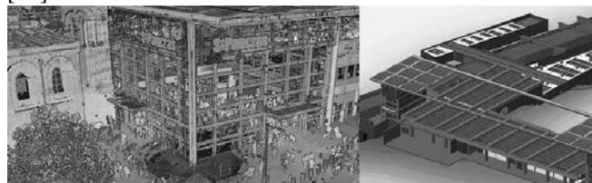
Рис. 34. Облако точек лазерного сканирования St Pancras 3D (слева) и автоматически созданная BIM-модель (справа) [66]
