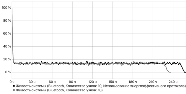
Рис. 6. Сравнительный график живучести системы (Bluetooth, 10 узлов, область 200 на 200 метров) с включенным/выключенным протоколом маршрутизации с идентификацией устройства
